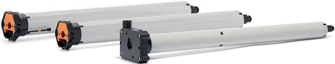
Die Rohrantriebe VariEco M-868 / VariEco M sind geeignet für Rollläden und textilen Sonnenschutz (ab 50 mm). Als Antrieb der M-Baureihe in Funk- und Nicht-Funk-Ausführung eignet er sich mit einem Durchmesser von 45 mm und einer Länge ab 491 mm ideal für platzsparende Systeme. Es stehen 6 bis 50 Nm und je nach Ausführung 10 bis 35 Upm zur Verfügung. Bis zu einem Bemessungs-Drehmoment von max. 20 Nm sind viele dieser Antrieb mit einer geräuschlosen
