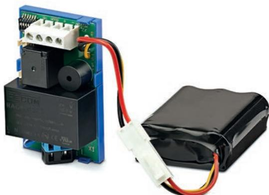
Tast- oder Selbsthaltebetrieb, Vorrang Einzel- oder Zentralbedienung, Rollladen- oder Jalousiebetrieb, Warnsignal bei niedrigem Ladezustand, automatische Auffahrt bei niedrigem Ladezustand (deaktivierbar), Warnsignal nach 2 Jahren bzw. 500 Ladezyklen (deaktivierbar), Bediengeräte mit Automatikbefehlen integrierbar.
