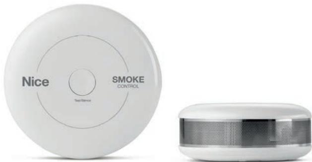
Smoke-Control signalisiert Alarm durch Ton, optisches Blinken und durch das Senden von Z-Wave-Steuerbefehlen. Der optische Sensor erkennt Rauch bereits in einem frühen Stadium des Feuers. Darüber hinaus verfügt das Gerät über einen eingebauten, programmierbaren Temperatursensor. Smoke-Control kann an einer Wand oder Decke angebracht werden. Die LED-Anzeige signalisiert Feuer und Betriebsmodus und kann verwendet werden, um zu sehen, ob sich das Gerät innerhalb eines Z-Wave-Netzwerks befindet.
