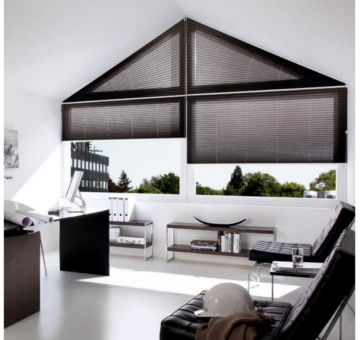
Vom Trapez über Schrägen bis zum Sechseck – verspannte Anlagen eignen sich bestens für spezielle Fensterformen. Die in die Schienenprofile eingearbeiteten Stoffkeder unterstreichen die hochwertige Optik der Systeme.
